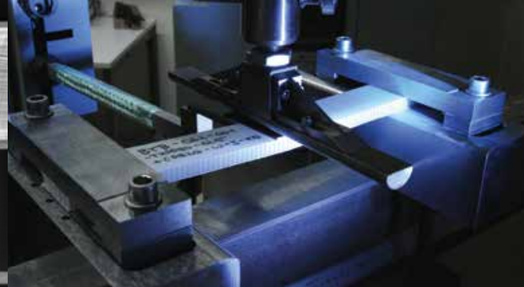
Sandwich-Biegeversuch mit seitlicher Einspannung
