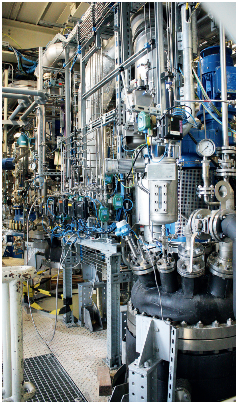
Kautschuksynthese im Pilotmaßstab (600 L Reaktor).
