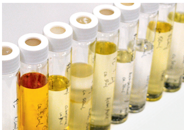
Abbildung 3. Phasenauftrennung von Latexkomponenten (links) und Zusammensetzung im Löwenzahnkautschuk (rechts).
