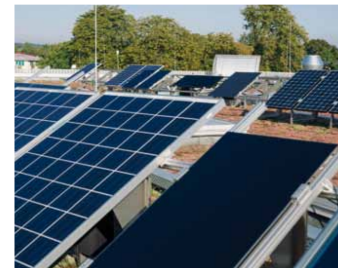
Photovoltaik-Park mit verschiedenen Solarmodulen für Versuchszwecke am Fraunhofer-Center für Silizium-Photovoltaik CSP.
