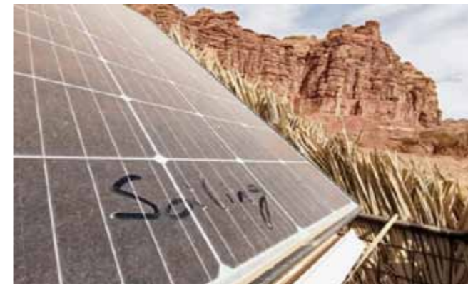
Lagert sich Schmutz auf Photovoltaikmodulen ab, erreicht weniger Licht die Solarzellen und der Stromertrag sinkt. Das Problem ist vor allem für den wachsenden Einsatz von Photovoltaik in Wüstengebieten und Regionen mit starker Luftverschmutzung relevant. © Fraunhofer CSP
