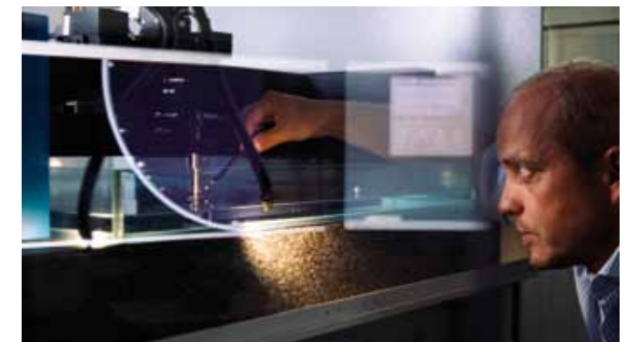
Mit akustischer Mikroskopie lassen sich kleinste Risse in Materialien erkennen, ohne die Proben zu zerstören.
