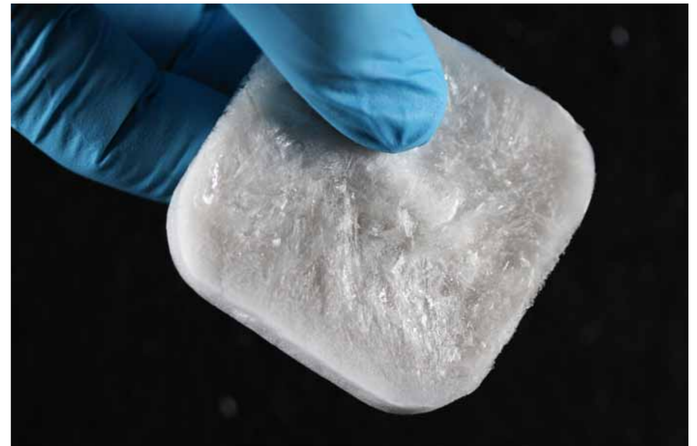
Elastinbasierte Proteinschwämme imitieren die Eigenschaften der Haut und sind durch ihr hohes Quellvermögen sehr gut für die Behandlung tiefer Wunden geeignet.
