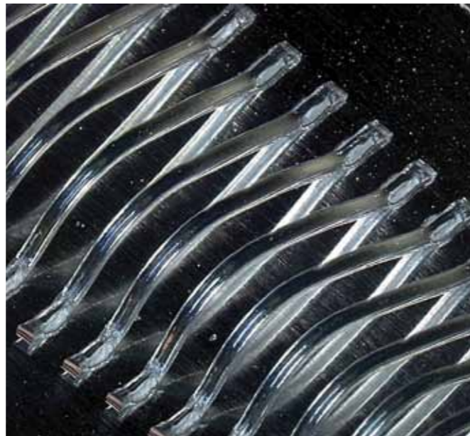
Reihe von Aluminium-Dickdrahtkontakten als Prüfmuster zur Untersuchung der Mikrostruktur-Eigenschaftsbeziehungen.
