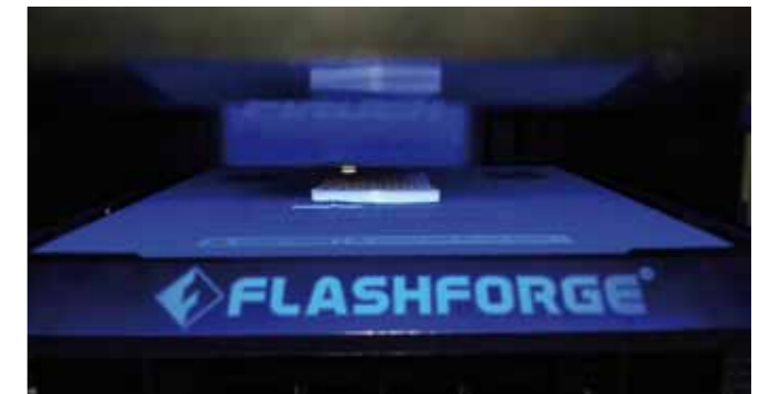
3D-Druck kann eingesetzt werden, um Füllkörper zum Einsatz in der Wasseraufbereitung herzustellen.
