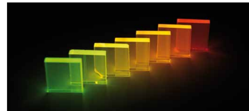
Mit verschiedenen Metallionen angereicherte lumineszierende Gläser unter Anregung mit ultraviolettem Licht.
