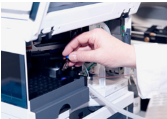
Prüfung der Freisetzung des Wirkstoffs unter Gute Laborpraxis-Bedingungen mittels Massenspektrometrie und HPLC (high performance liquid chromatography).
