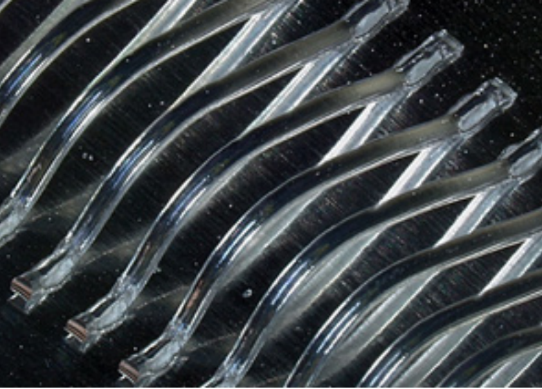
Reihe Aluminium-Dickdrahtkontakte als Prüfmuster zur Untersuchung der Mikrostruktur-Eigenschaftsbeziehungen.
