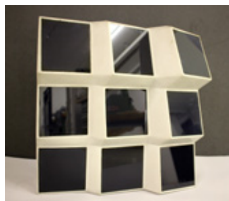
Fassadenelement C3: Das Modulare Photovoltaik-Modulkonzept für das Fassadenelement in Facetten-Optik macht einen deutlich höheren Stromertrag möglich.
